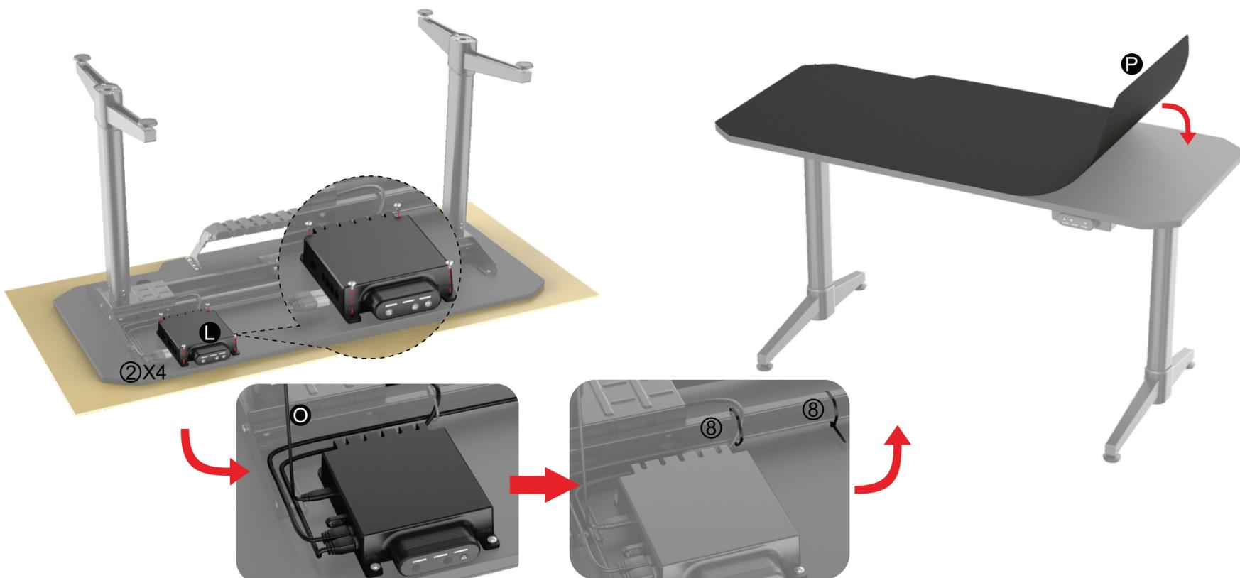
Verwende einen Kabelbinder, um die Kabel zu befestigen.
